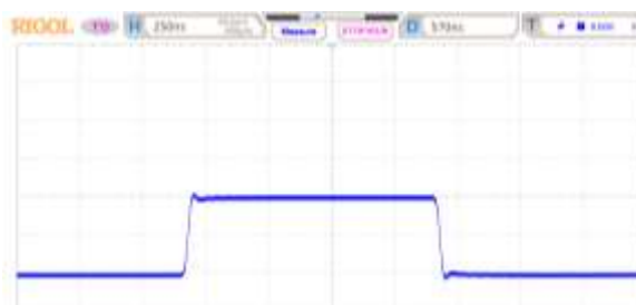
Рис. 1. Прямоугольный однополярный импульс возбуждения феррозондового преобразователя
