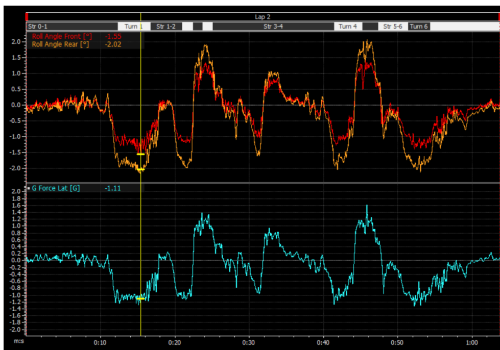
Рис. 2. Графики боковой жесткости подвески и поперечной нагрузки
