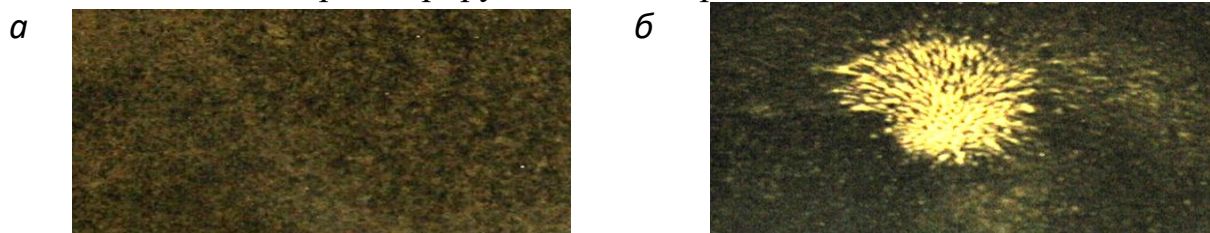
Рисунок 2 – Расположение доменов магниточувствительной жидкости от вектора напряженности магнитного поля
