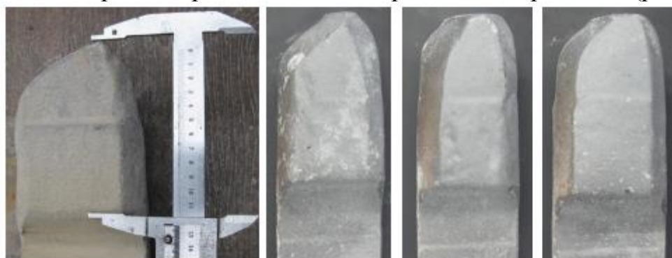
Рис. 1. Поврежденные молотки после дробления твердого сырья
