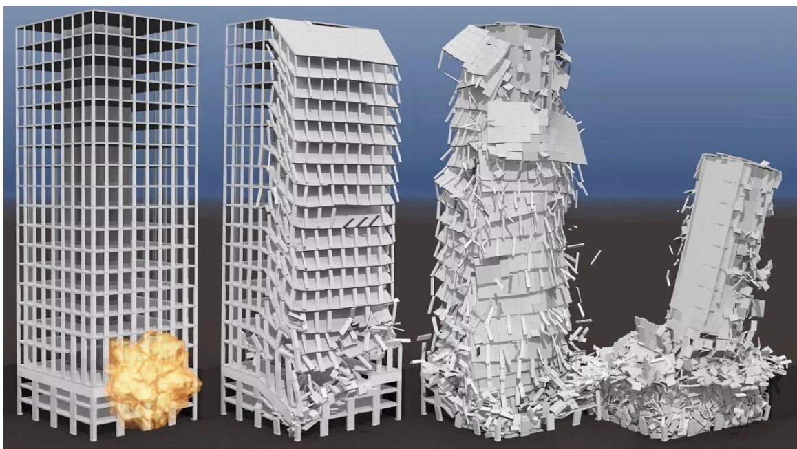
Рисунок 1 – Механизм прогрессирующего разрушения
