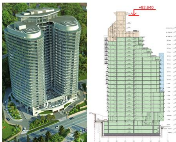
Рисунок 1 – Высотное здание с двумя подземными этажами
