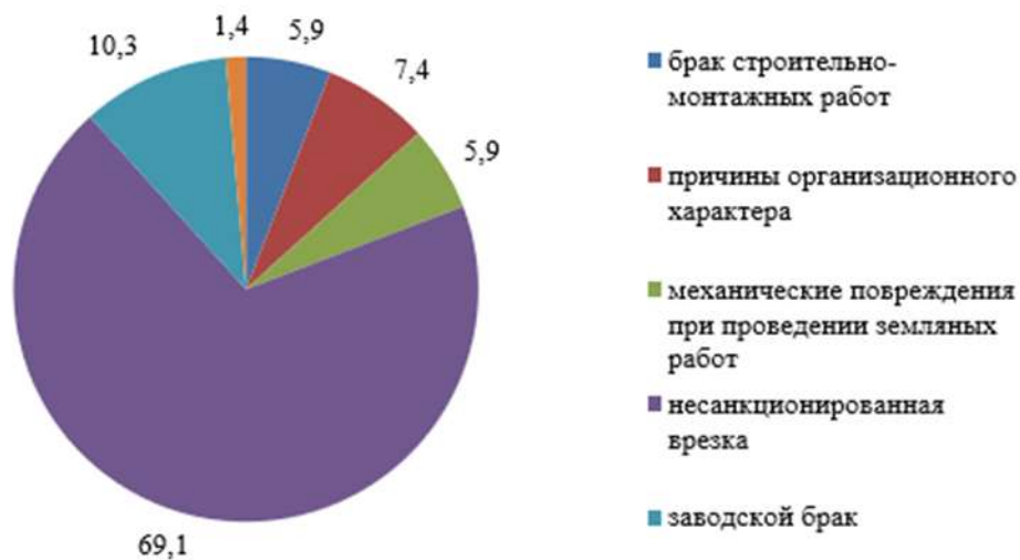
Рисунок 4. Основные причины возникновения аварийных ситуаций на объектах нефтегазодобывающей промышленности, %
